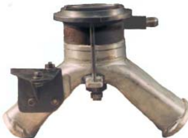
Рис. 3. Смеситель системы питания в сборе.
